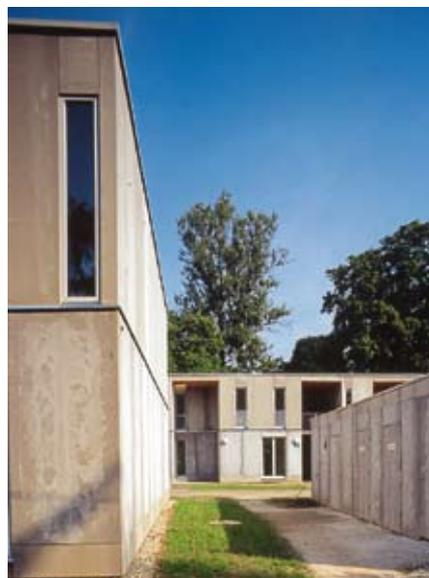
Haupt- und Nebengebäude sind in Holzständerbauweise errichtet worden. Die Konstruktion wurde mit Faserzementplatten verkleidet.
