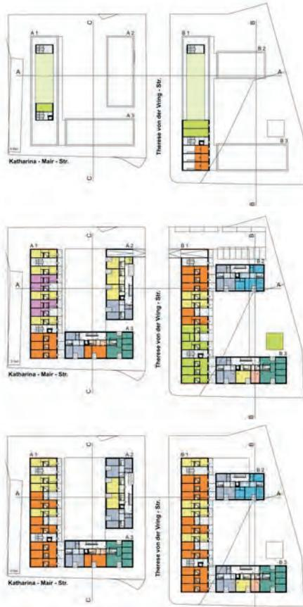
Schemata der Nutzungsverteilung im Erdgeschoss, Regelgeschoss und Dachgeschoss
