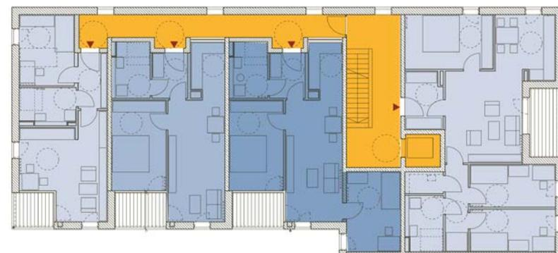
Querliegende Treppenhäuser teilweise kombiniert mit Innengängen erschließen vier Wohnungen pro Geschoss und Aufzug. Im Vergleich zur klassischen Spännerlösung können so mehr Wohnungen erreicht werden. Eine Querlüftung der kleineren Wohnungen ist nur über den Gang möglich.
