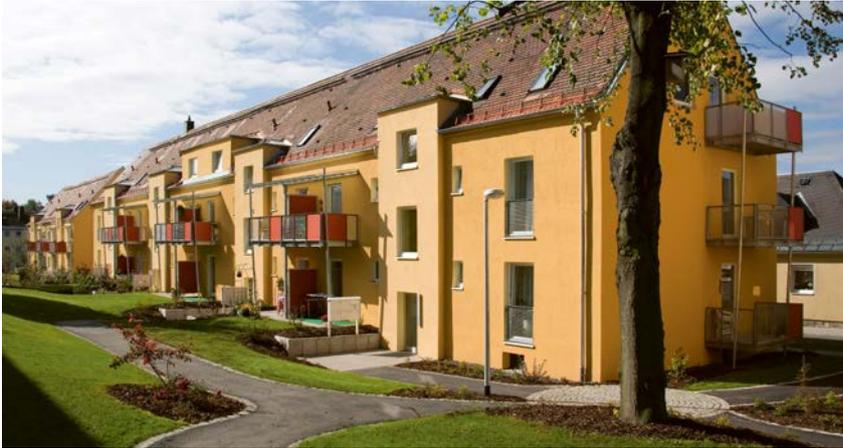
Die Randbegrenzungen der barrierefreien Wege und der Wechsel im Plattenbelag bei der Wegkreuzung ermöglichen eine taktile Orientierungshilfe für blinde oder visuell eingeschränkte Menschen. Die Beleuchtung markiert Kreuzungspunkte auch im Dunkeln.
