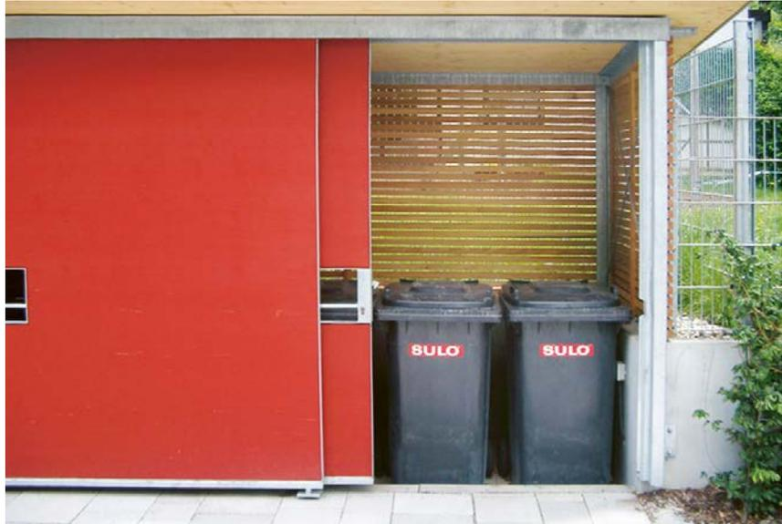
Abgesenkte Mülltonnen können von kleinen Menschen oder Menschen im Rollstuhl besser erreicht werden. Durch eine Öffnung des Abstellplatzes nach hinten kann die Mülltonne für die Entleerung herausgeschoben werden.
