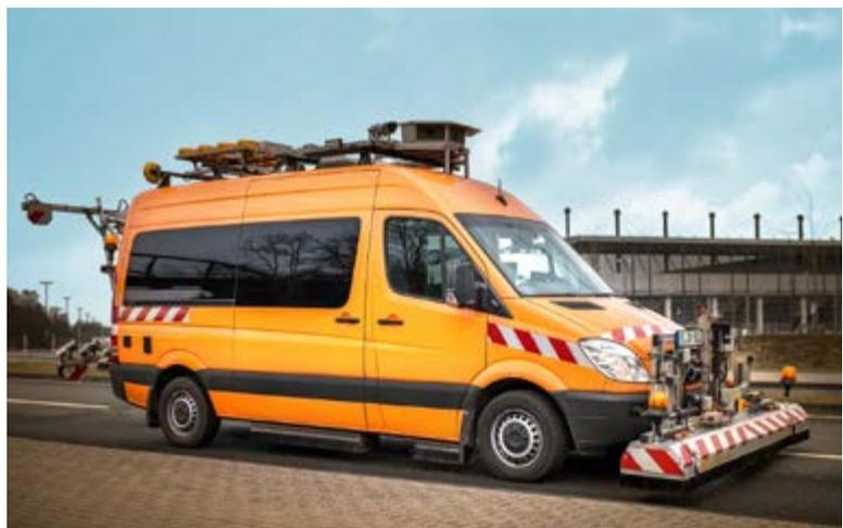
Multifunktionales Messsystem zur Erfassung des oberflächigen Fahrbahnzustands
