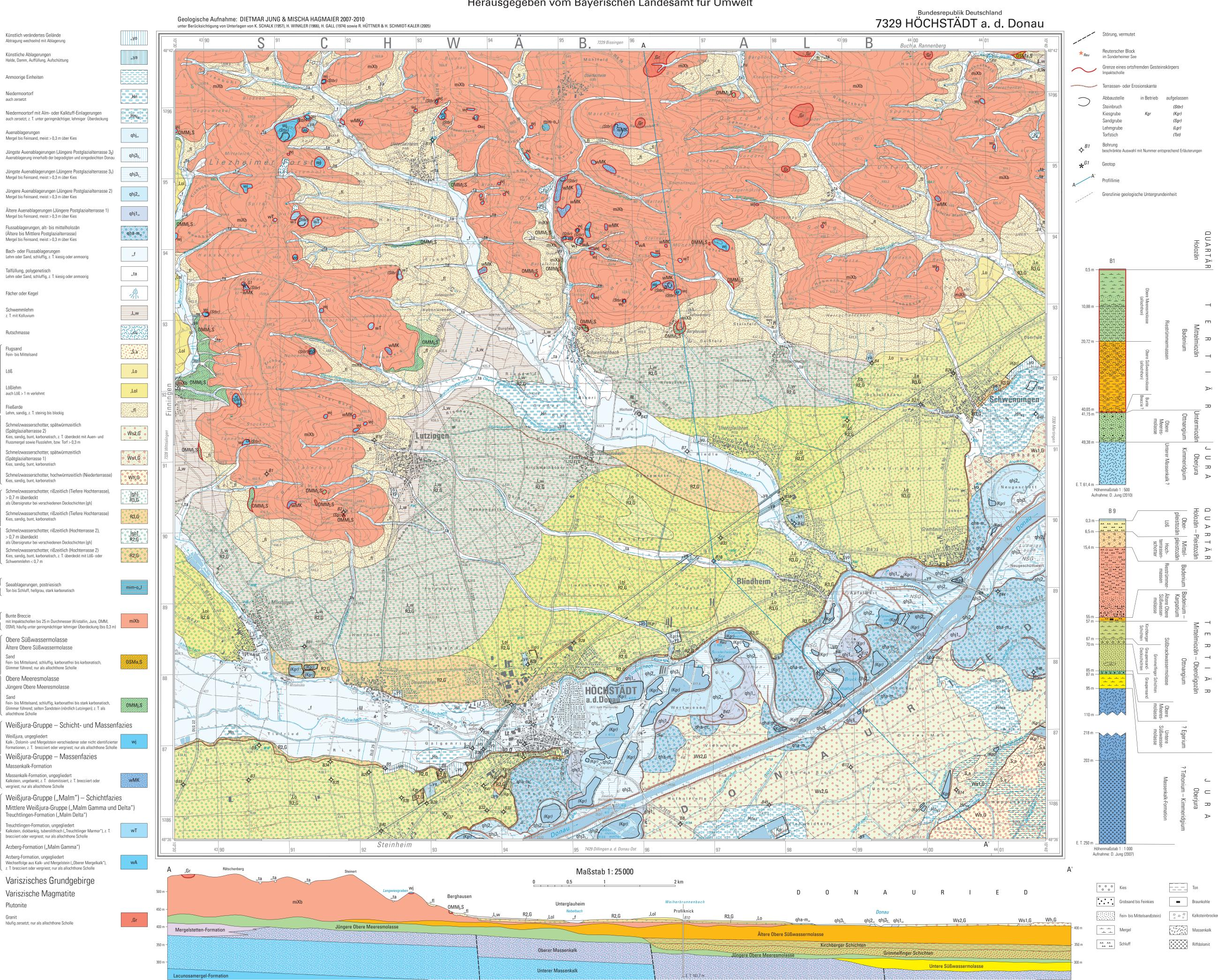
Profil 5fach überhöht (geringmächtige Deckschichten z. T. vernachlässigt, z. T. übertrieben), Geländeoberkante abgeleitet aus dem digitalen Geländemodell 25 (DGM 25), Gitterweite 25 m
