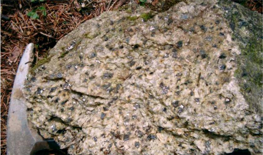
Abb. 16: Heller, gleichkörniger „Haidmühler Granit“ mit den charakteristischen Biotit-Blättchen und -Aggregaten
