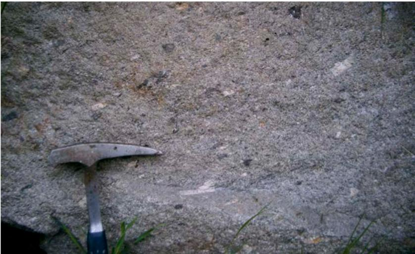
Abb. 17: Grauer, überwiegend gleichkörniger „Haidelgranit“ mit charakteristischen, einzelnen Kalifeldspat-Einsprenglingen und biotitreichen Aggregaten
