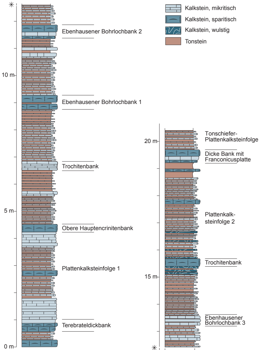
Abb. 14: Teilprofil durch den Oberen Muschelkalk 1, aufgenommen beim Bau der BAB 71 südöstlich von Rottershausen (A 9). Das Profil setzt etwa 8 m über der Grenze Mittlerer Muschelkalk/Oberer Muschelkalk an. Gezeichnet nach einer Aufnahme von HENZ & SELL (2006: 364ff.) (vergleiche Kapitel 5).
