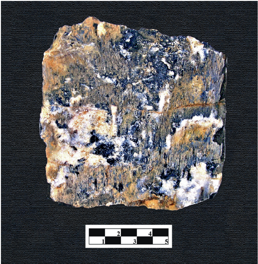
Abb. 42: Foto eines Kalkstein-Lesesteines aus dem Oberen Muschelkalk 1+2 aus der Kissingen–Haßfurter Störungszone NE Holzhausen. Die Oberfläche zeigt deutlich erkennbar eine Gleitstriemung, die senkrecht zur Schichtung steht. Ausmaße etwa 12 x 12 cm.
