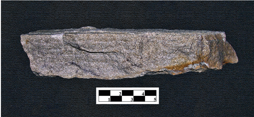
Abb. 27: Handstück des Anoplophorasandsteins (Rothhausen, A 20). Erkennbar ist die Feinschichtung des grün-grauen Feinsandsteins ebenso wie Wurzelreste (vergleiche Unterer Sandstein), Maßstab in cm
