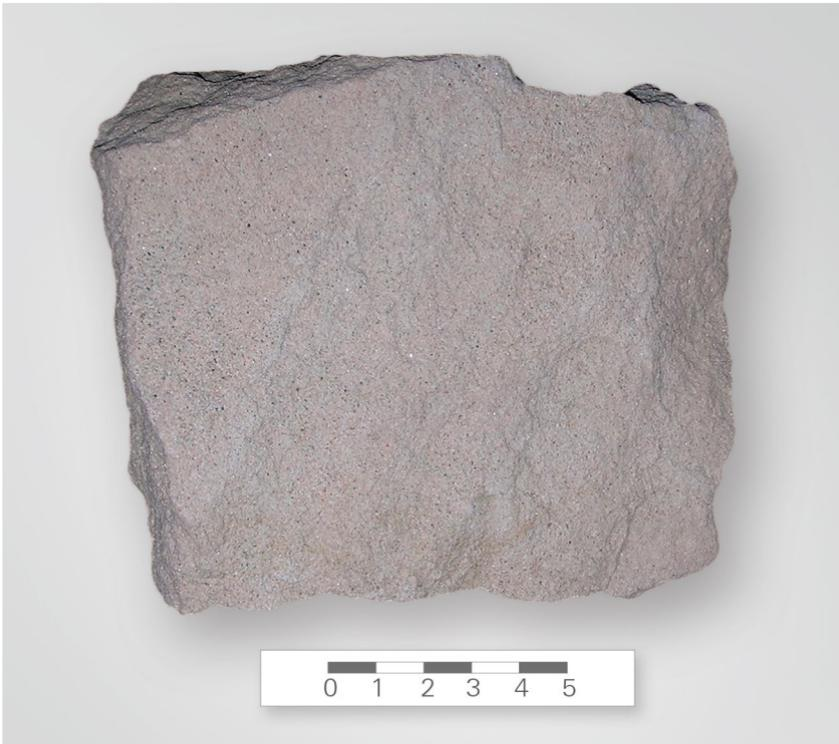
Abb. 16: Handstück aus dem Coburger Sandstein mit typischer rosabeiger Farbe und erkennbarer Glimmerführung (Unterer Werkstein, N Neudorf), Maßstab in Zentimeter
