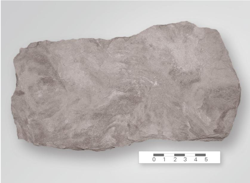
Abb. 4: Lesestein aus dem Schilfsandstein N Wustviel mit deutlich erkennbaren Glimmeranreicherungen an den Schichtflächen, Maßstab in Zentimeter
