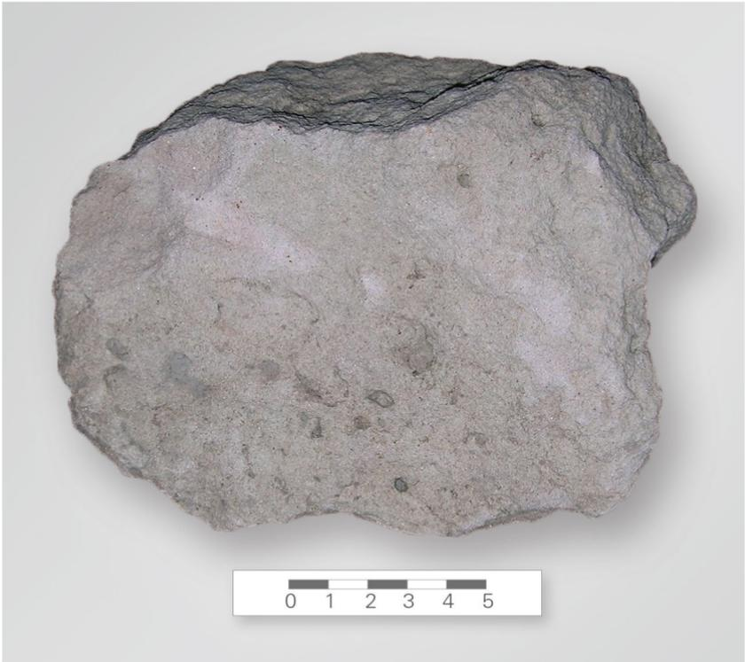
Abb. 22: Lesestein aus dem Unteren Burgsandstein NW Schindelsee. Typisch ist auch hier das wiederholte Auftreten von grüngrauen Tonschluffstein-Gallen, die blasenartige Hohlräume erzeugen. Maßstab in Zentimeter
