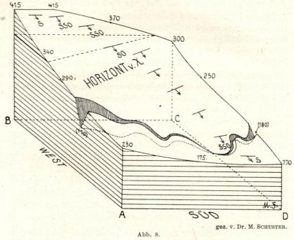
Schematische Darstellung des Streichens und Fallens der X-Chirotheriumquarzitschicht im Bereiche des Blattes Hammelburg-Nord. Die gewundene Kerbe ist der Einschnitt der Saale in die genannte Schicht.
