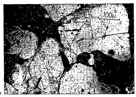
Abb. 10. Diaplektisches Andesinglas mit Hornblende. Amphiboliteinschluß im Suevit von Alerheim.
