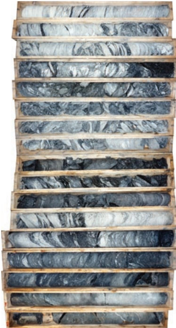
Abb. 4. Kataklastische Störungszone im Grenzbereich Glimmerschiefer zu Amphibolit (451 bis 468 m).
