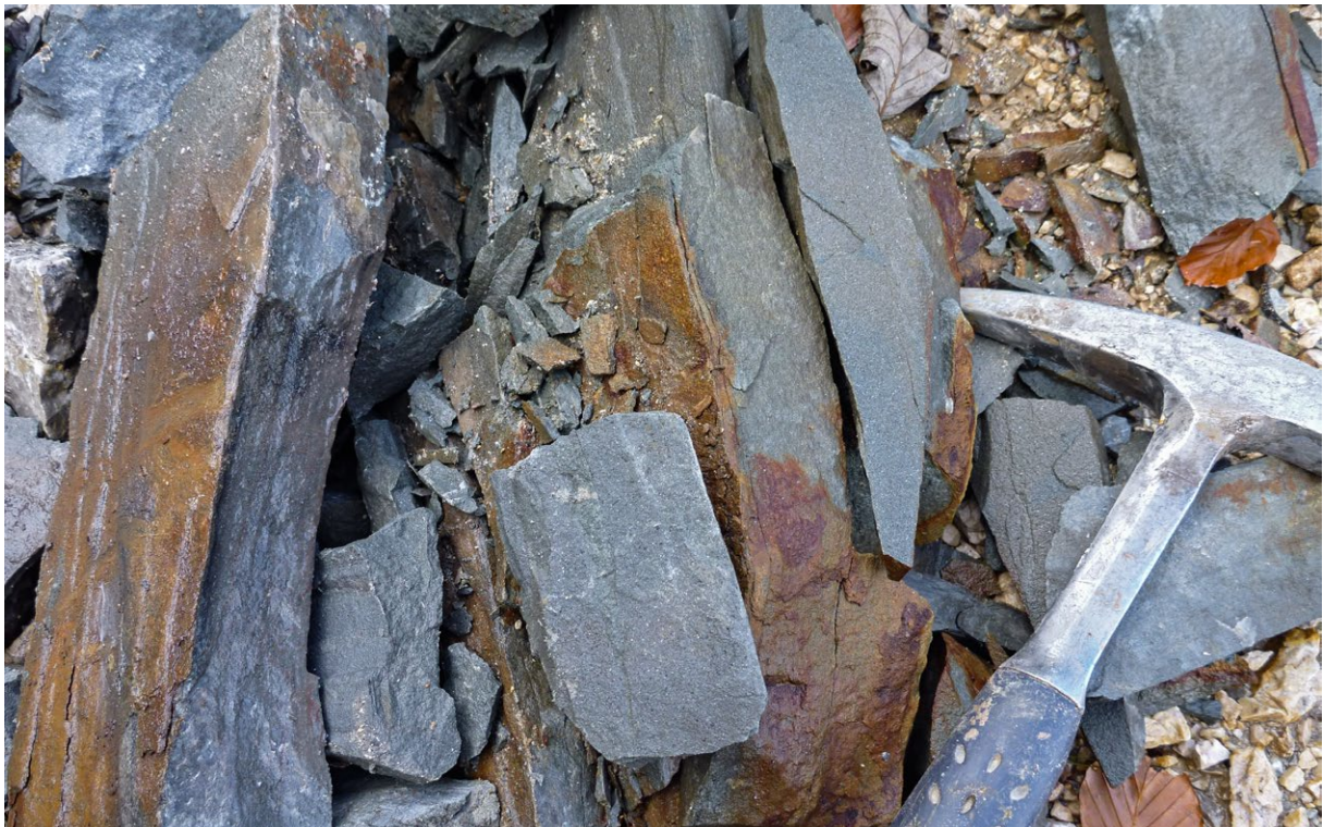
Abb. 44: Schwarzgraue, karbonatisch gebundene Feinsandsteine, mit kräftig ockerfarbenen Verwitterungsfarben, Raibl-Formation (Steinbruch, S Fischbach am Inn)
