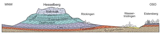
Schematisches Profil der Schichtfolge am Hesselberg
