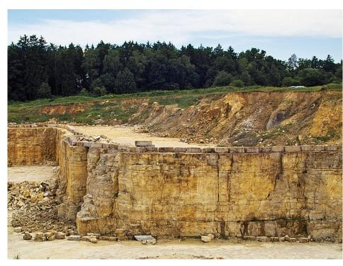
Im Steinbruch Gundelsheim sind die Schlifffläche im Malmkalk und die darüber geglittenen Trümmermassen deutlich sichtbar.
