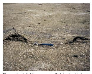
Blasenartige Aufwölbungen an der Steinbruchsohle durch Aufquellung bei der Umwandlung von Anhydrit zu Gips
