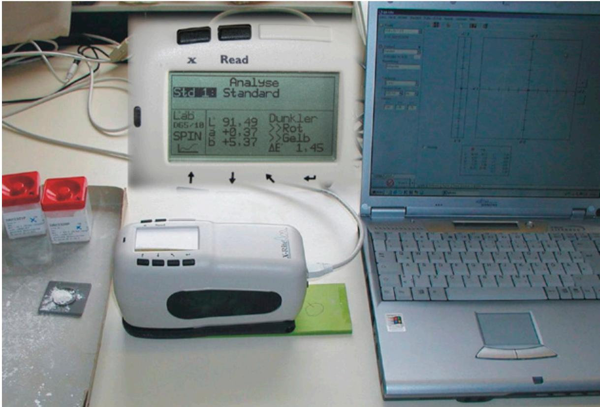
Abb. 3-4: Verwendetes Weißgradmessgerät (Spektralphotometer) der Firma X-Rite
