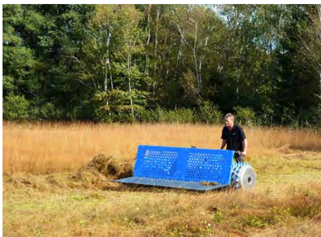
Abb. 7: Neu entwickelte Techniken ermöglichen die effizientere Bewirtschaftung von Nasswiesen. Beispielsweise montierbare Räumschilde/Heuschieber und funkferngesteuerte Balkenmäher mit einer Arbeitsbreite von bis zu sieben Metern ermöglichen die Bewirtschaftung selbst von kaum noch begeharen Feuchtfelder (Fotos: Uwe Kießling).
