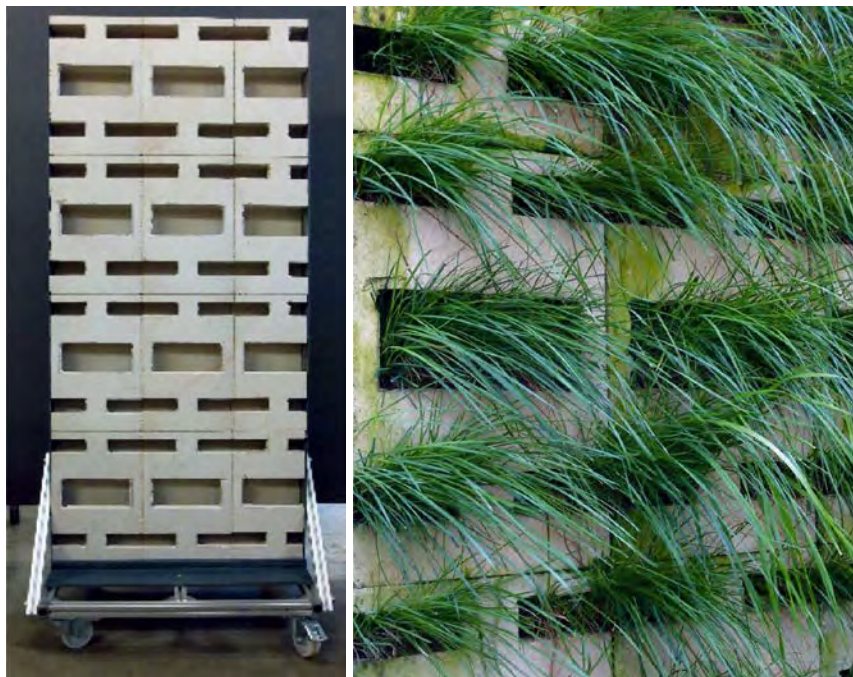
Abb. 2: Funktionsmodul zur vertikalen Begrünung im Rohzustand (links) und nach zwei Monaten Versuchslaufzeit (rechts).
