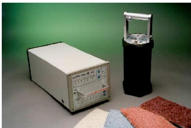
Das CarPID™ ist ein tragbares, batteriebetriebenes Handgerät, leichter als 3 kg, welches zur Vorsortierung oder beim Teppichhändler vor Ort eingesetzt werden kann. Eine Identifikation der jeweiligen Fraktionen erfolgt in zwei Sekunden.
