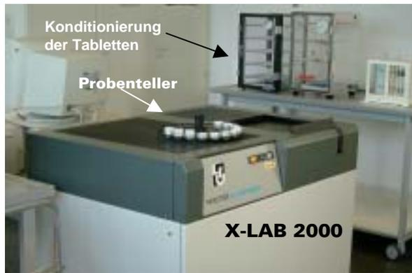
Abb. 3: Analysengerät mit Probenteller
