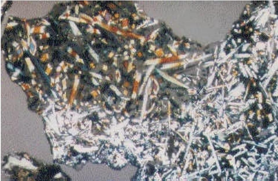
Abb. 15: Polarisationsmikroskopische Ansicht eines Schlacke-Dünnschliffs; 10-fache Vergrößerung
