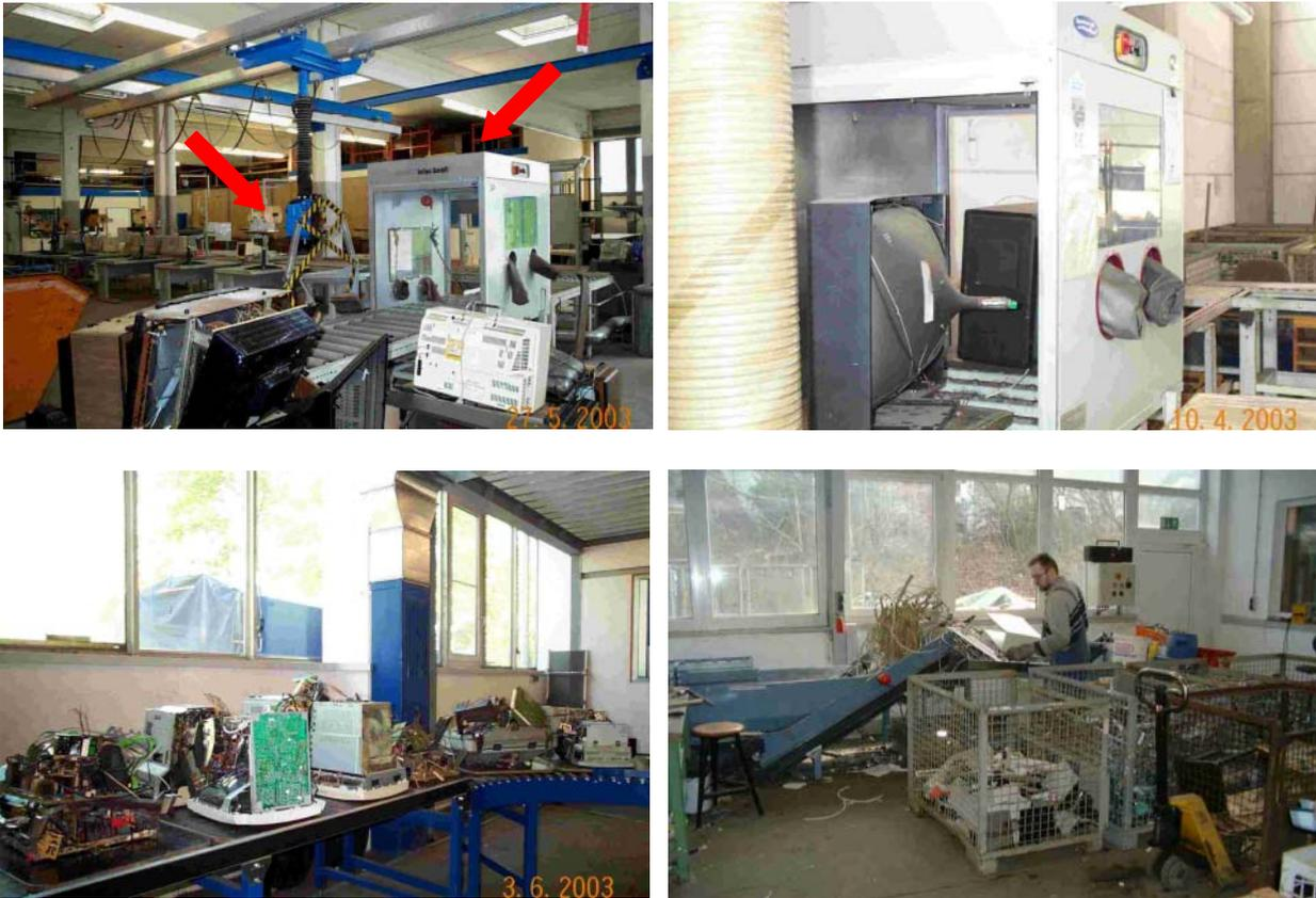
Abbildung 3.13: Demontage von Elektro(nik)-Altgeräten entlang eines Rollbandes
