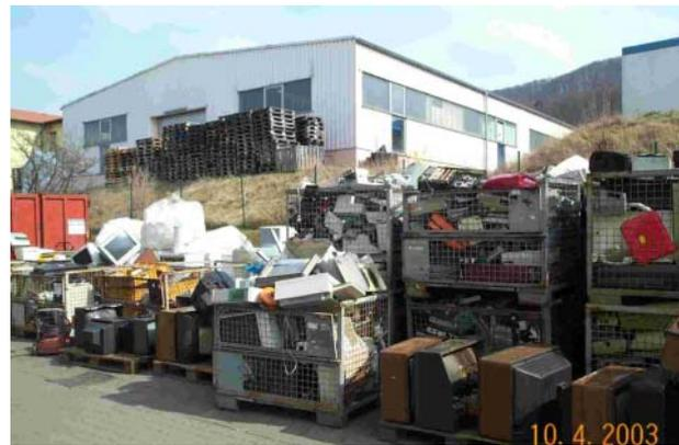
Die weitere Behandlung der Elektro(nik)-Altgeräte ist in allen befragten Einrichtungen eine manuelle Demontage der Geräte. Nur in Ausnahmefällen werden kleinere Elektro(nik)-Altgeräte mit einem geringen Schad- und Wertstoffpotenzial, wie z.B. PC-Tastaturen, Haarföhne, Rasierapparate etc., aussortiert und direkt an entsprechende Shredderbetriebe oder Müllverbrennungsanlagen weitergegeben.
