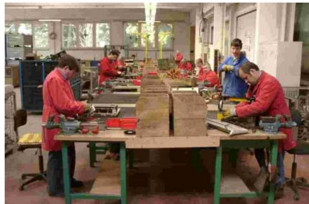
Abbildung 3.12: Manuelle Demontage von Elektro(nik)-Altgeräten an Einzelarbeitsplätzen
