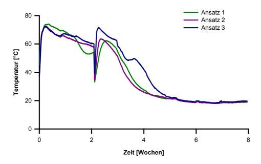
Abb. 3-1: Verlauf der Maximaltemperaturen in den Ansätzen A1, A2 und A3 während der Reaktorrotte
