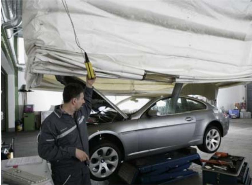
Abb. 2: Verfahrbare Kabine für die Pyrotechnikneutralisation
