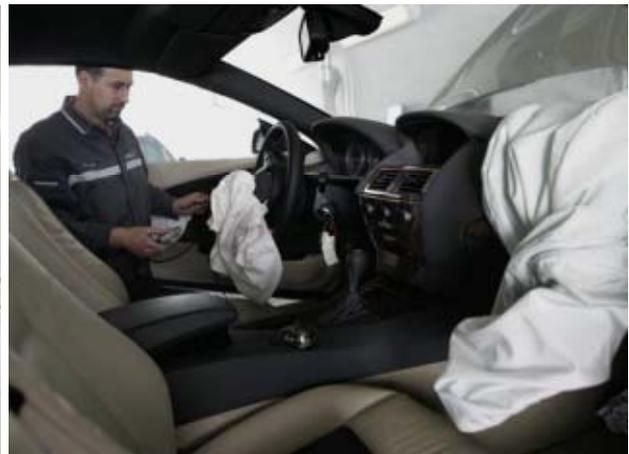
Abb. 3 und 4: Neutralisation der Pyrotechnischen Einheiten
