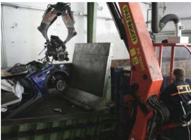
Abb. 7: Separation von Restkarosse und Motorgetriebeblock
