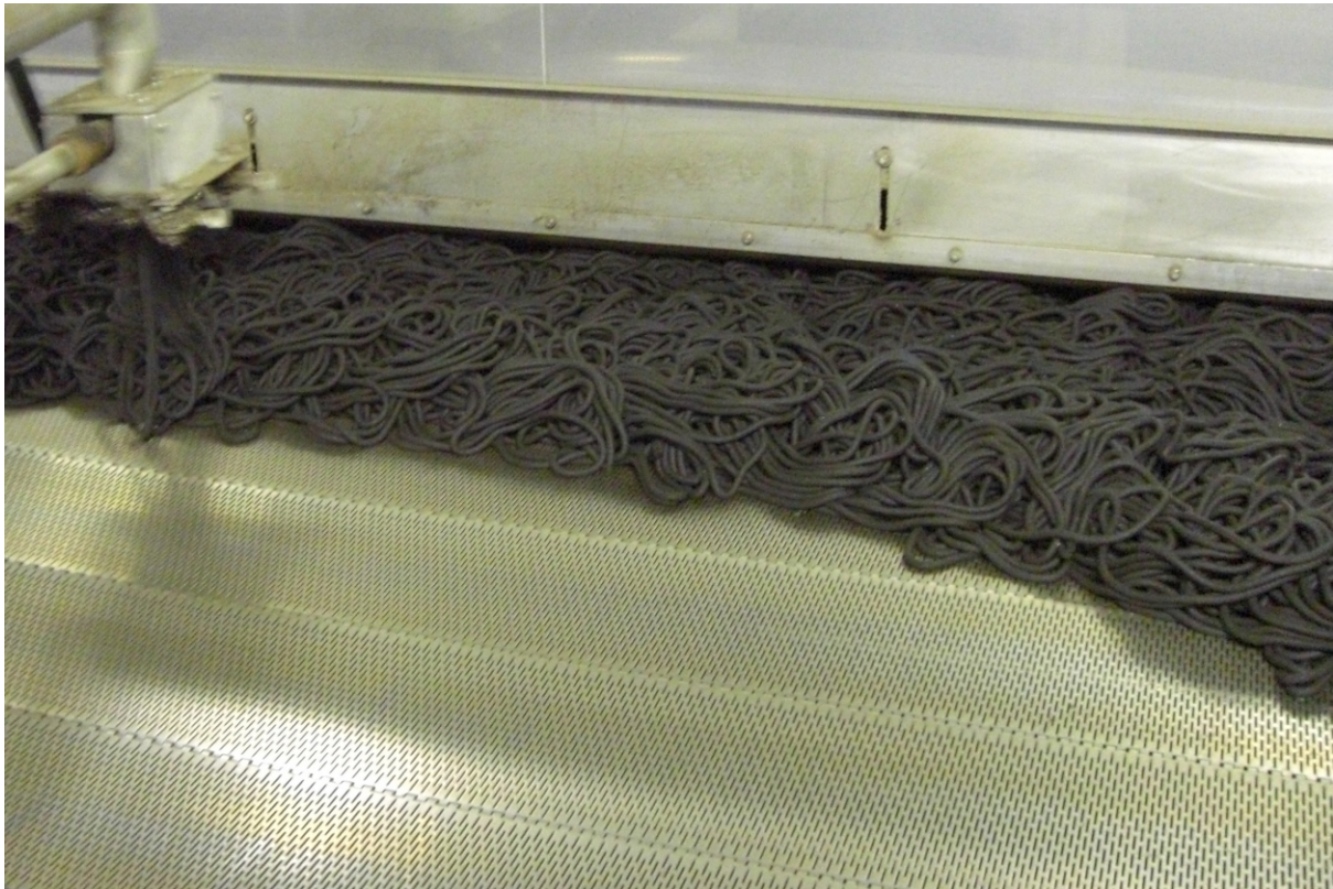
Abb. 8: Trocknerband mit Klärschlamm-Presslingen
