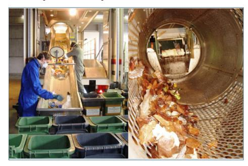
Abb. 2: Blick auf das Aufgabeförderband (links) und in die zweistufige Siebtrommel, vom Trommelauslauf gesehen (rechts).
