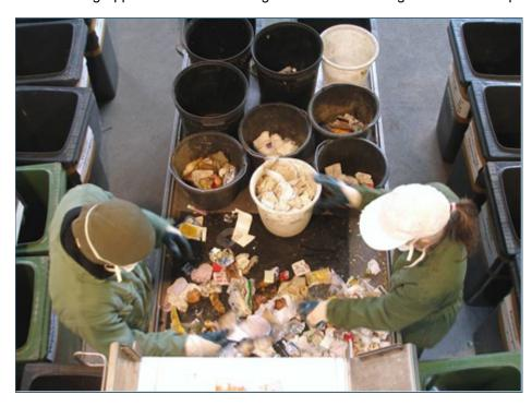
Abb. 3: Draufsicht auf den Sortiertisch bei der Sortierung der Grobfraktion von Restmüll.
