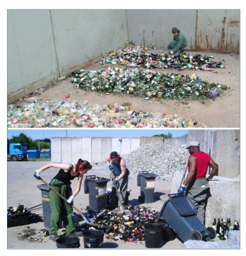
Abb. 5: Abgekippter Inhalt eines Drei-Kammer-Glascontainers (oben), Sortierung von Braunglas in die vier Glasfraktionen und weitere Stoffgruppen (vgl. Tab. A-1 im Anhang).
