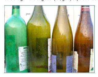
Abb. 6: Beispiele für eine Farbabstufung von grünem zu braunem Behälterglas (von links nach rechts).
