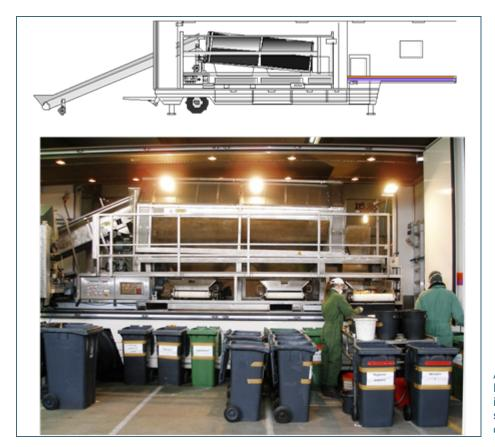
Abb. 1: Mobile Sortieranlage im Einsatz (schematische Darstellung oben).
