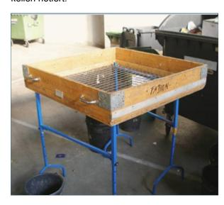
Abb. 4: Siebkasten mit Maschenweite 40 mm für die Papiersortierung.
