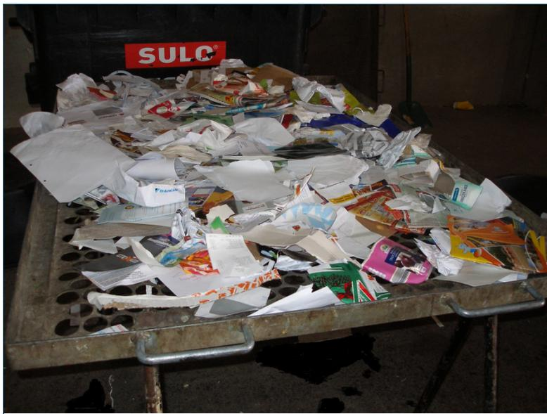
Abb. 7: Vom Altpapier übrig gebliebene Grobfraction auf dem Lochsieb (Maschenweite 40 mm)
