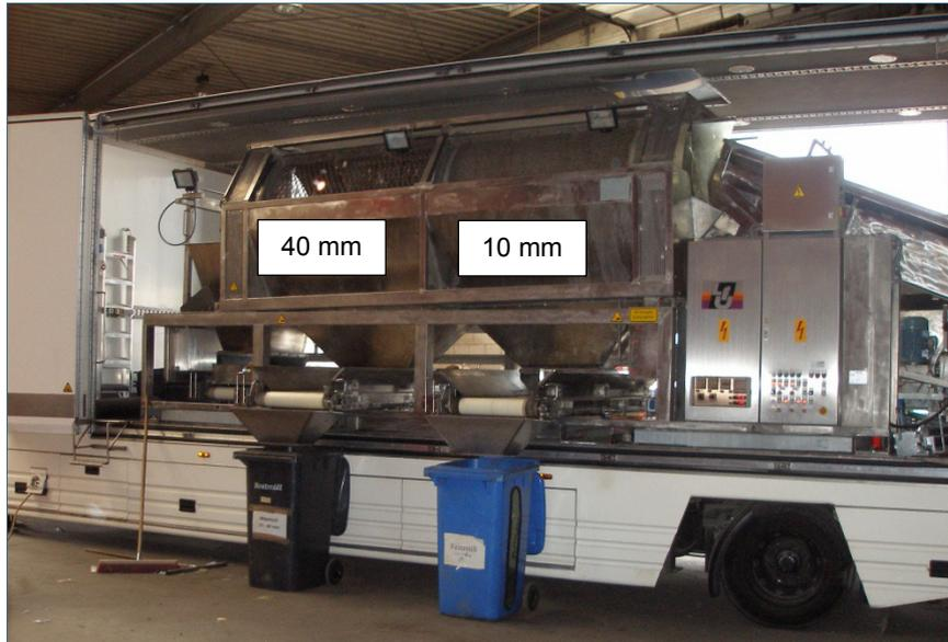
Abb. 5: Seitenansicht (links) der mobilen Abfallsortieranlage mit den Austragsförderbändern für die Fein- und Mittelfraktion in 240 l Behälter
