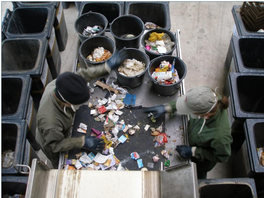
Abb. 6: Manuelle Sortierung der Grobfraktion des Restmülls auf dem Sortiertisch
