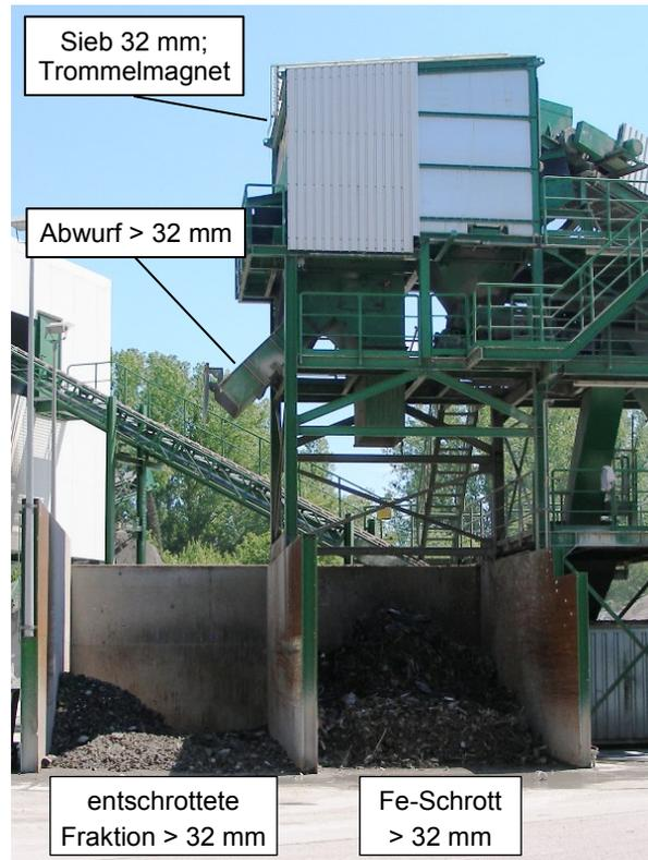
Abb. 15: Teil der Aufbereitungsanlage der Anlage IV
