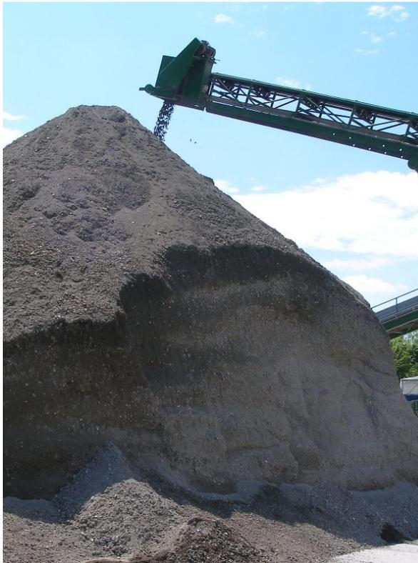
Abb. 14: Abwurf der Fraktion  $< 32$  mm der Anlage IV
