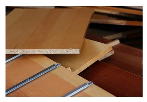
Bild 5: Typisches Möbelholz mit Metallanteilen (AWM)
