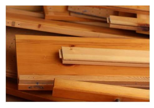
Bild 4: Vermeintlich unbehandeltes Altholz (tatsächlich lackiertes Massivholz, kein A I) (AWM)
