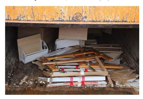
Bild 6: Typisches A IV Holz mit hohen Kunststoffanteilen zur Erfassung zusammen mit Sperrmüll (Presscontainer beim AWM)
