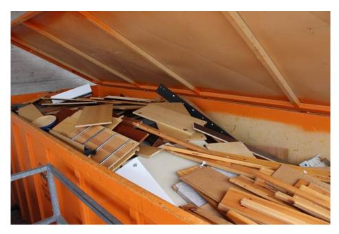
Bild 1: Typisches A I bis A III Holz (AWM)
