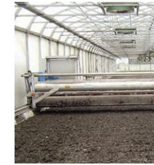
Anlage zur solaren Trocknung von Klärschlamm
