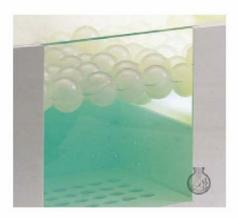
Schwimmkugeln zur Abdeckung von Flüssigkeiten Bild: Laborhandel Zwickau
