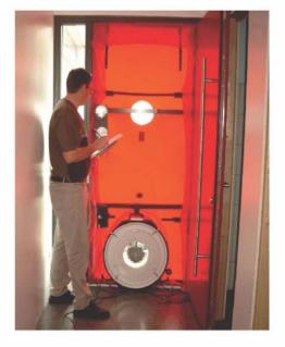
"Blower-door-Test" zur Überprüfung der Luftdichtheit eines Gebäudes
