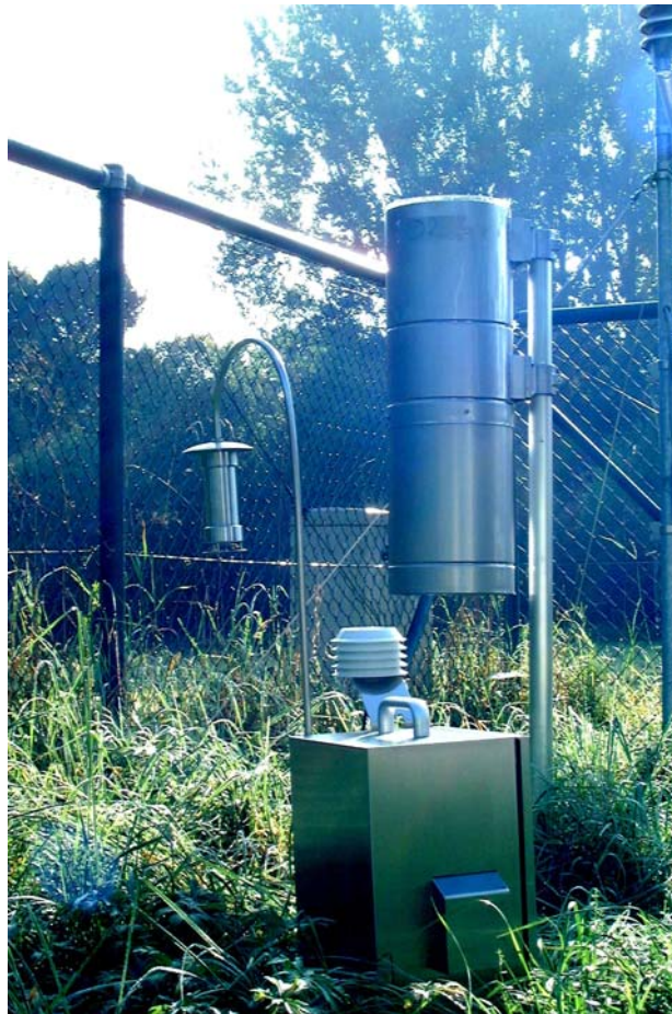
Abb. 4: Dauerbeobachtungsstation Augsburg mit Messeinheit: Immission (vorne) und Deposition (hinten)
