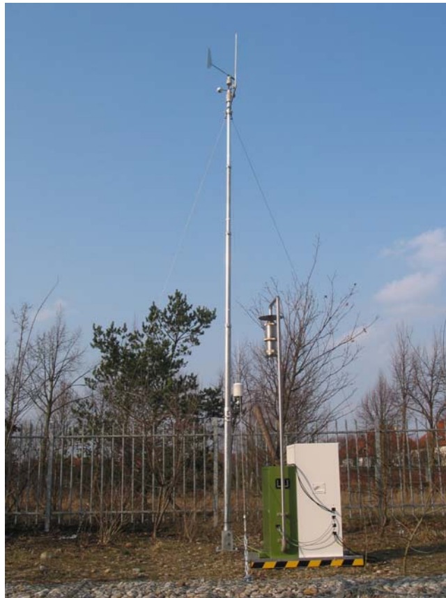
Abb. 8: Windrichtungsabhängige Probenahme am LfU in Augsburg
