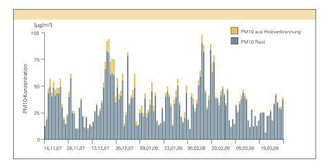
Abbildung 6: Verlauf der PM10-Konzentration und des Anteils aus der Holzverbrennung an der LÜB-Messstation Augsburg-Königsplatz
