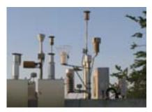
Probenahmevorrichtungen für Feinstaub und gasförmige Luftschadstoffe auf dem Dach einer Messstation
