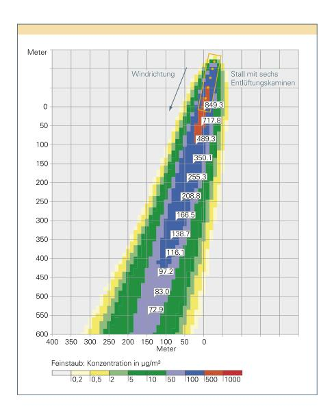
Entfernungsabhängige Feinstaub-Belastung (in μg/m³), die von einem Masthähnchenstall mit 120.000 Tierplätzen (Bodenhaltung) ausgeht (maximale Stundenmittelwerte). Staubfracht bei voller Belegung etwa 1,3 kg/h, davon 59 % als PM<sub>10</sub> (Korngröße kleiner 10 μm) und 9 % als PM<sub>2,5</sub> (kleiner 2,5 μm). www.lfu.bayern.de: Abfall >
