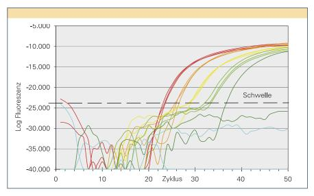
Mit Hilfe von "Source tracking"-Methoden ist es möglich, der Herkunft fäkaler Verunreinigungen auf die Spur zu kommen. Eine von der TU Wien entwickelte molekularbiologische Methode wird derzeit am LfU auf ihre Praxistauglichkeit getestet. Dabei weist man definierte DNS-Abschnitte nach, die speziell nur aus menschlichem oder tierischem Kot stammen: Mit der sogenannten Real-Time-PCR-Analytik werden die gesuchten DNS-Abschnitte quantifiziert.
