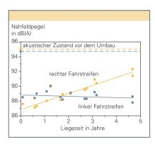
B 17 bei Augsburg: Rollgeräusche vor und nach Einbau des "Flüsterasphalts" (Pegel in unmittelbarer Nähe des Reifens bei 80 km/h). Auch nach fünf Jahren Liegezeit vermindert er den Verkehrslärm deutlich.
