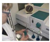
Die neu entwickelte, fotometrische Anilinbestimmung folgt einem exakten Zeitplan, da mit instabilen Lösungen gearbeitet wird
