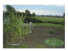
Mit Lysimetern wird eine mögliche Schadstoffverlagerung aus dem aufgebrachten Klärschlamm in Boden und Grundwasser analysiert.
