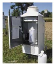
Ein elektrisch gekühlter "Wet-Only-Sammler". Er sammelt nur "nasse" Niederschläge (Regen, Schnee) im Unterschied zu anderen, die auch "trockenen" Niederschlag (= Staub) erfassen.
