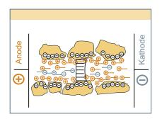
Wassergesättigte Klärschlammasche im Gleichstromfeld: Phosphat löst sich und wandert als negativ geladenes Ion zur Anode.
