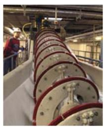
Die "Schnecke" zur Trennung von Festund Flüssigstoffen vor der Aufbereitung der Halbleiterschichten.
