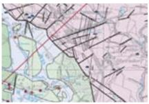
Die Geothermie-Rahmenbedingungskarten im Maßstab 1:50000 zeigen, welcher Anlagentyp in welchen Gebieten geeignet ist und wo mit Einschränkungen zu rechnen ist, wie z. B. in Wasser- und Heilquellenschutzgebieten oder in Gebieten mit bekannten Bohrrisiken wie z. B. im Karst oder bei ungünstigen Grundwasserverhältnissen.
