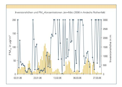
Abbildung 3: Mittlere tägliche Feinstaubkonzentration (Säulen) und Höhe der Inversionsschicht (blaue Linie) vom 02.01. bis 31.03.2006 an der LÜB-Station Andechs
