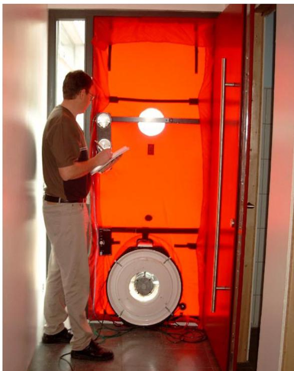
Abb.5: Luftdichtheits-test zur Feststellung der Qualität der Bauausführung
