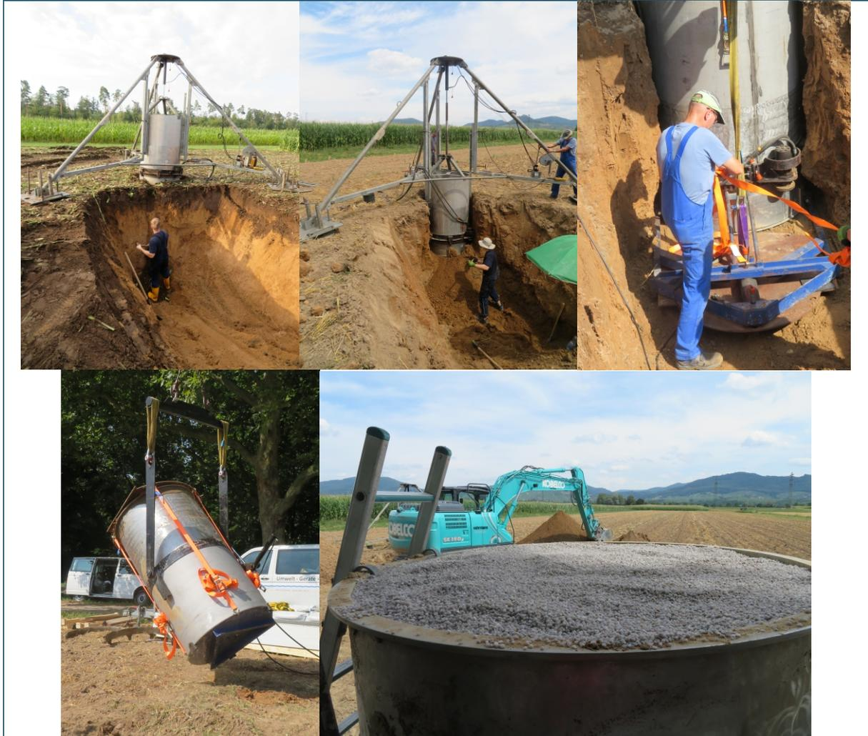
Abb. 1: Vorgang Lysimeterentnahme: Bild 1 Aufbau Lysimeterentnahmevorrichtung, Bild 2 Einfräsen des Lysimeterzylinders in den Boden, Bild 3 Verschließen des Zylinders zur Entnahme, Bild 4 Drehen des Zylinders, Bild 5 Einbau des Quarzsandfilters in die Lysimeterunterseite
