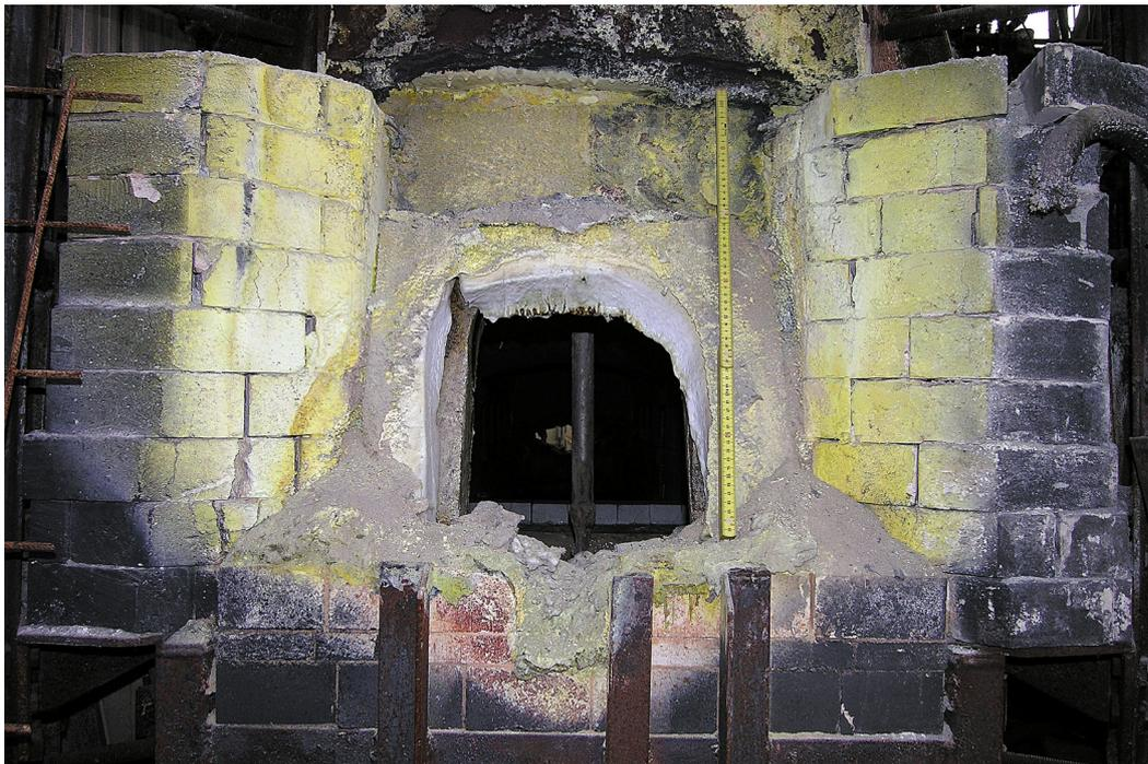
Abb. 1: Stillgelegter Schmelzofen; Gelbfärbung im Bereich der Ofentür durch Arsenverbindungen
