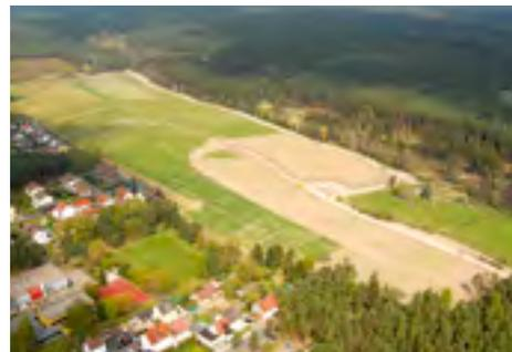
Auf den 18 Hektar großen Kiesgruben lagerte die Stadt Weiden von 1950 bis 1959 sowie von 1968 bis 1999 rund 1,5 Millionen Kubikmeter Hausmüll, Gewerbeabfälle und Bauschutt ab. Eine wirksame Basisabdichtung bestand nicht, wodurch über Jahrzehnte Schadstoffe in das Grundwasser sickerten. Durch die Abreinigung des Grundwassers von 2003 bis 2009 und das Aufbringen einer wirksamen Oberflächenabdichtung im Jahr 2006 ist eine zukünftige Gefährdung für das Grundwasser nicht mehr zu befürchten.
