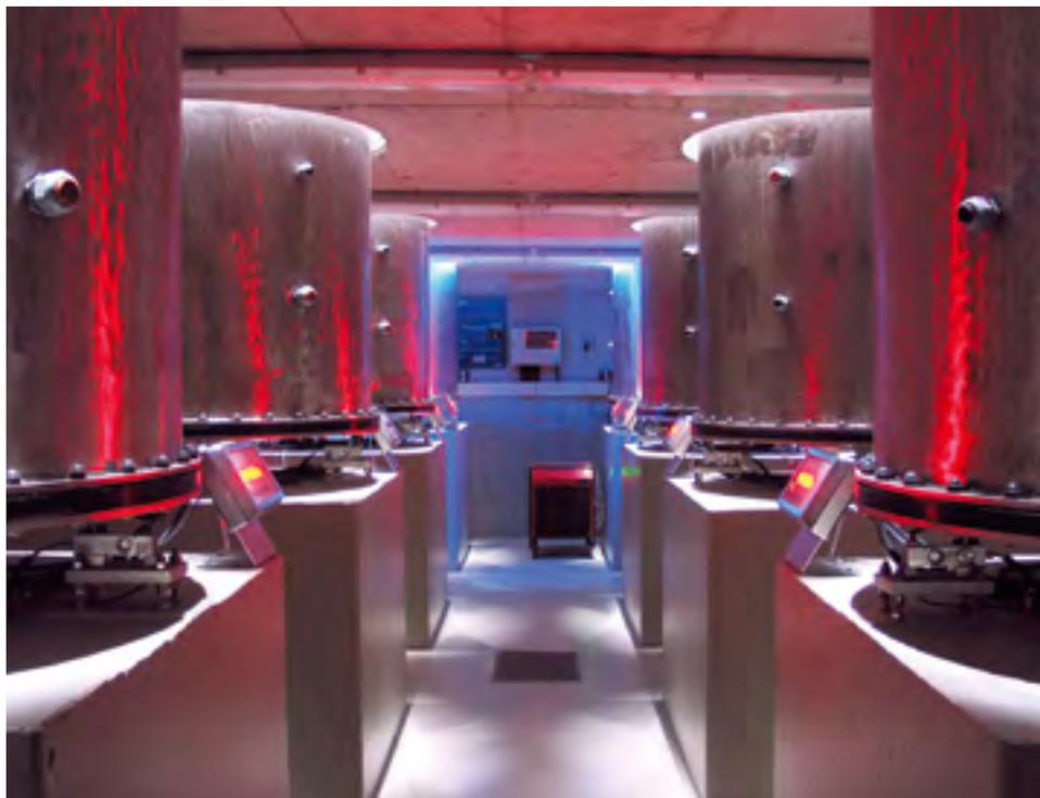
In der → *Lysimeteranlage* in Wielenbach wird das Stoffverhalten im Sickerwasser von Böden untersucht.
