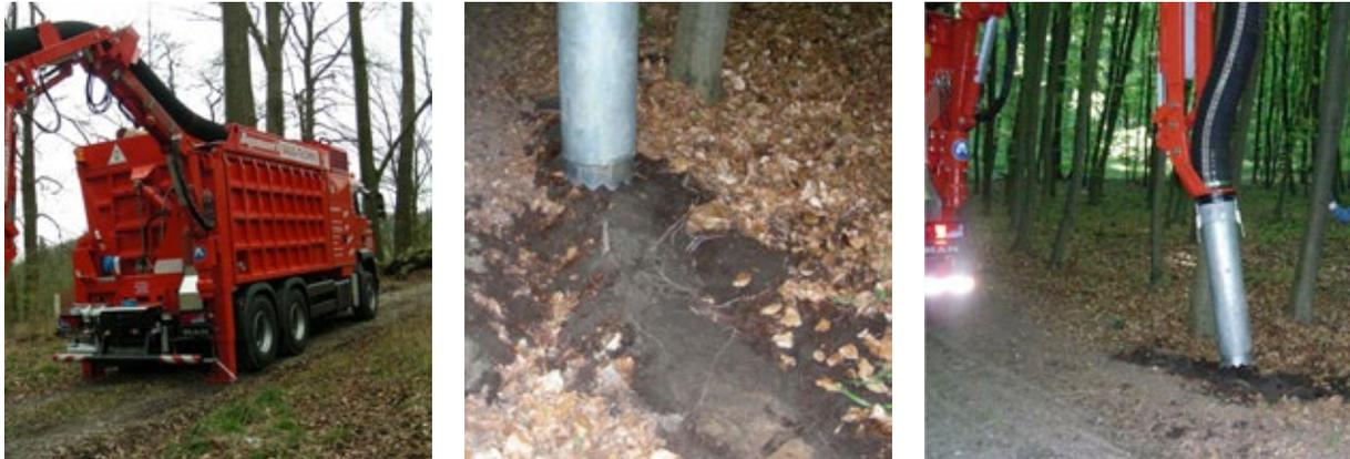
Abb. 6: Saugbagger im Feldversuch WSSA Lemgo-Luerdissen
