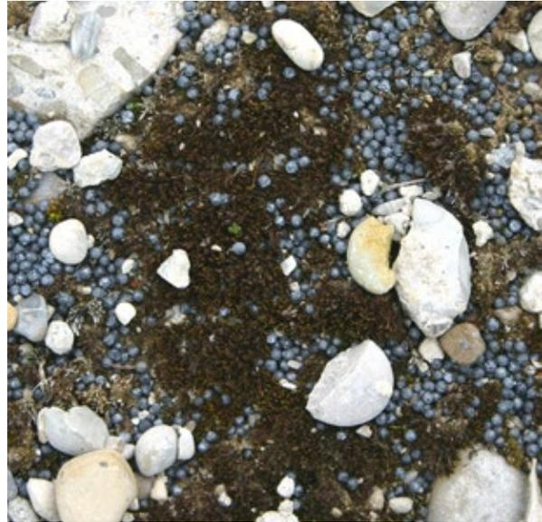
Abb. 2: Bleikugeln in korrodiertem Zustand.
