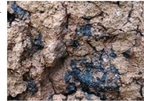
Typische Trockenrisse und dunkle Eisen-Mangan-Flecken
