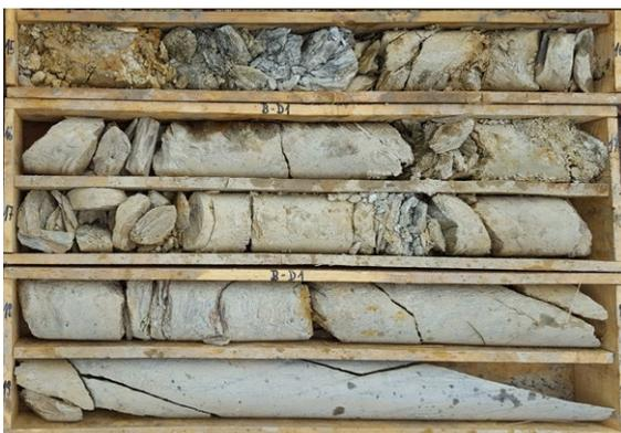
Abb. 17: Quarzit (unterster Bohrmeter, 19-20 m) und Nebengestein (Quarzglimmerschiefer mit hohem Quarzanteil, 16- ca. 19 m); Baugrundbohrung B-D1, Ortsumgehung Schirnding; Foto: Ingenieurbüro Dr. Ruppert und Felder GmbH.
