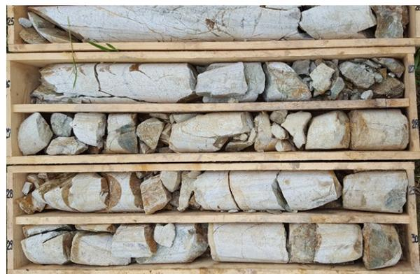
Abb. 18: Mehrere m mächtige Quarzitlage (25-30 m), Baugrundbohrung B-A2, Ortsumgehung Schirnding; Foto: Ingenieurbüro Dr. Ruppert und Felder GmbH.
