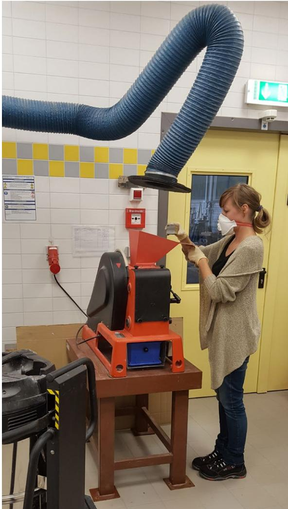
Abb. 19: Aufbereitung mittels Backenbrecher.
