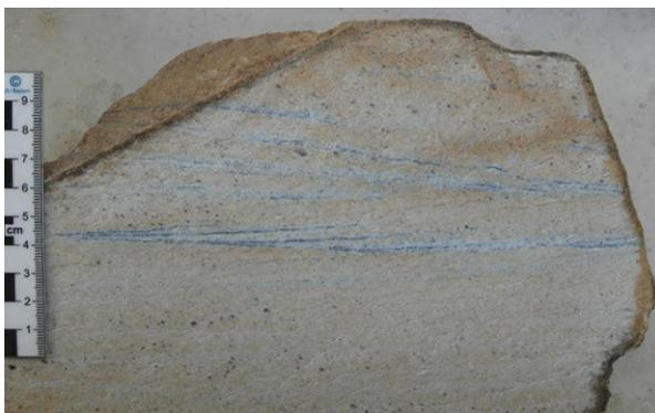
Abb. 7: Quarzit-Lesestein, gesägte Platte mit Schrägschichtungsstruktur; NE Putzenmühle; geol. Einheit „ofqw“.
