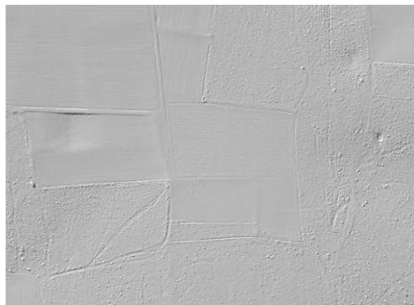
Abb. 7: Verfüllte Doline (aus Abb. 6) südwestlich Hundszell im Schattenbild (links südlich des Wegs).
