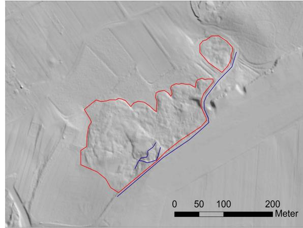
Abb. 5: Rutschmassenablagerung (rot) und sich rückverlagernde Anbruchkante (blau) der Rutschung südlich von Lindenhof im Schattenbild. Innerhalb der Rutschmasse sind in Blau zwei Zerreibungen markiert.
