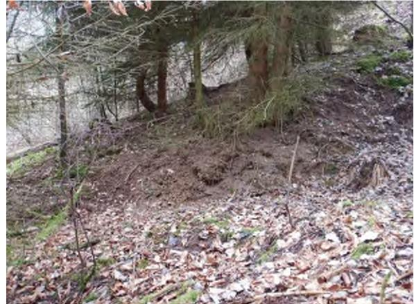
Abb. 23: Steile Rutschungsstirn mit freigelegter Erde einer Rutschung in den Lehrbergsschichten
