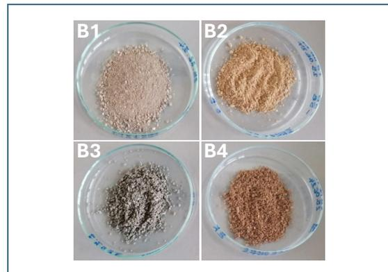
Abb. 4: Ausgangsmaterial gesiebt (< 2 mm) und getrocknet
