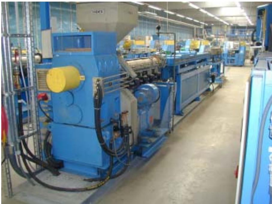
Abbildung 5-2: Produktionslinie Elektrorohr
