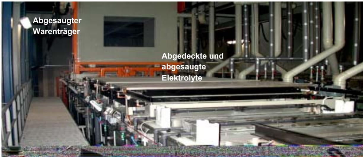
Abb. 15: Moderne Chemisch-Nickel-Linie, Bild: Thoma Metallveredelung GmbH
