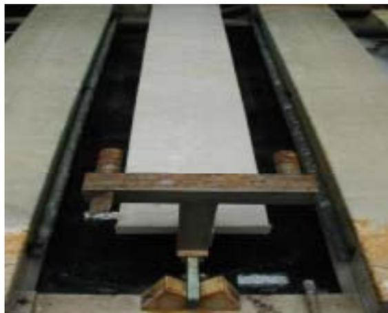
Abb. 14: Teilabdeckung am Gestellträger (Draufsicht), Bild: Thoma Metallveredelung GmbH
