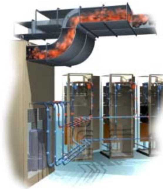
Abb. 10: Verlustwärmenutzung von Gleichrichtern durch Wasser-Luft-Wärmetauscher im Zuluftstrom
