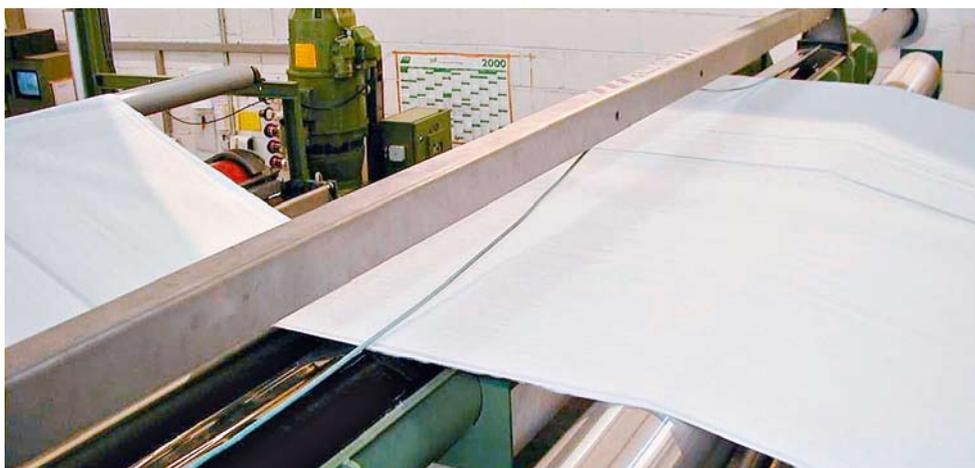
Vakuumsaugbalken zur Vortrocknung von Stoffbahnen in der Textilindustrie
