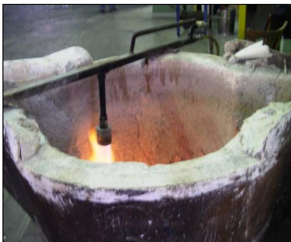
Abbildung 6-6: Pfannenaufheizung ohne Abdeckung mit erhöhten Wärmeverlusten
