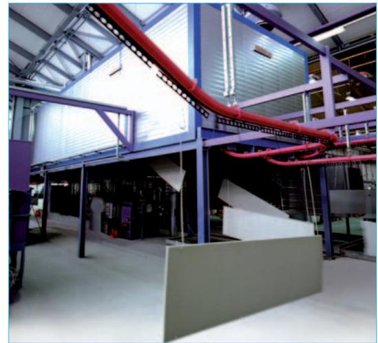
**Tipp:** Eine Reduktion der Trocknungstemperatur durch Entfeuchtung der Umluft kann eine Energieeinsparung bis zu 50 % bedeuten und vermeidet insbesondere für temperaturempfindliche Werkstücke lange Trocknungszeiten (Kälte- oder Sorptionstrocknung, siehe Abschnitt 5.5).
