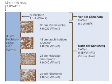
Dämmung einer Ziegelwand Dämmstoffe haben unterschiedliche Wärmedämmeigenschaften (N). Deshalb sind für den gleichen U-Wert verschiedene Stärken nötig.
