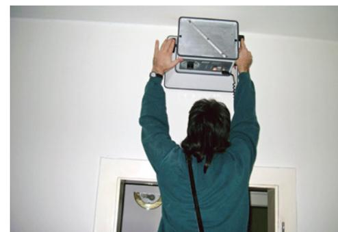
Messung des Volumenstroms eines Zuluftventils bei der Einregulierung der Anlage
