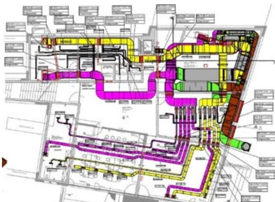
Abb. 11: Viatisschule – Lüftungsschema vor der planerischen Optimierung
